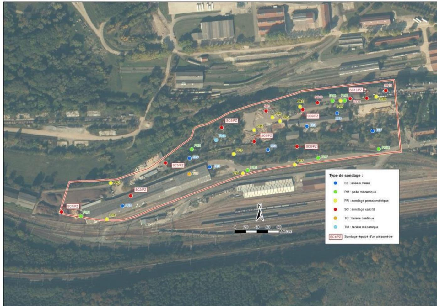
Figure 13 : Localisation des sondages sur le site du SMR
